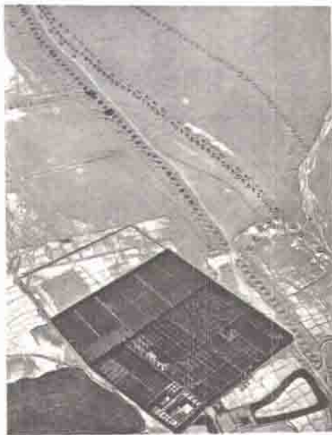
شکل ۶-۹- منظره هوایی دو رشته قنات در اطراف کرج
